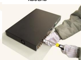
8) Зафиксируйте крышку винтами
