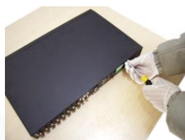
1) Открутите винты, фиксирующие крышку
