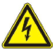
Предупреждение о наличии внутри корпуса изделия неизолированных электрических цепей, которые могут представлять опасность для человека. Для снижения риска поражения электрическим током не разбирайте устройство.
