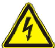
Предупреждение о наличии внутри корпуса изделия неизолированных электрических цепей, которые могут представлять опасность для человека. Для снижения риска поражения электрическим током не разбирайте устройство.
